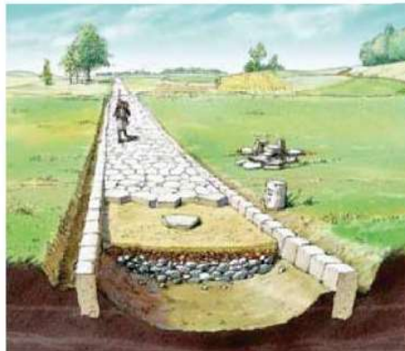
5 De aanleg van een Romeinse heerbaan. Reconstructietekening.
